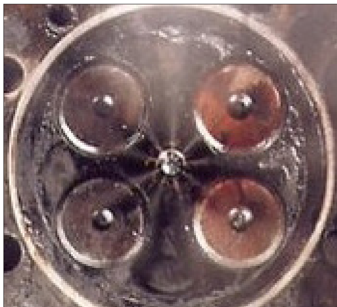
Une pulvérisation uniforme va nettoyer les injecteurs
